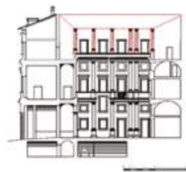
7. Ipotesi di ricostruzione del nucleo originario cinquecentesco di Palazzo Stati. Nel registro superiore, da sinistra a destra: pianta piano primo; prospetto laterale su via dei Coronari; pianta piano terra. Nel registro inferiore, da sinistra a destra: sezione longitudinale; sezione trasversale; prospetto principale.
